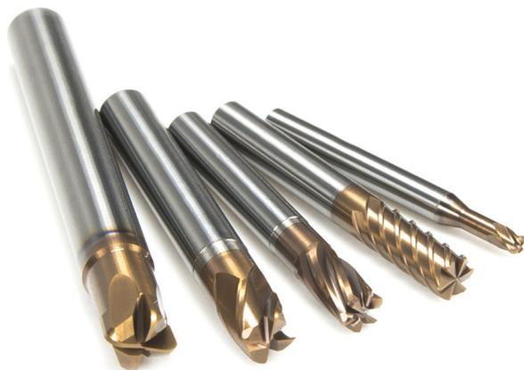
**EXTREME**, per lavorare acciai temprati con durezza fino a 67 HRC, utilizza geometrie fino a 6 taglienti a differenza degli utensili convenzionali. Queste geometrie permettono di eseguire la sgrossatura e la semifinitura in un'unica operazione, praticando tagli poco profondi e velocità di avanzamento estremamente alte, ottime per lavorazioni di fresatura in alta velocità.
